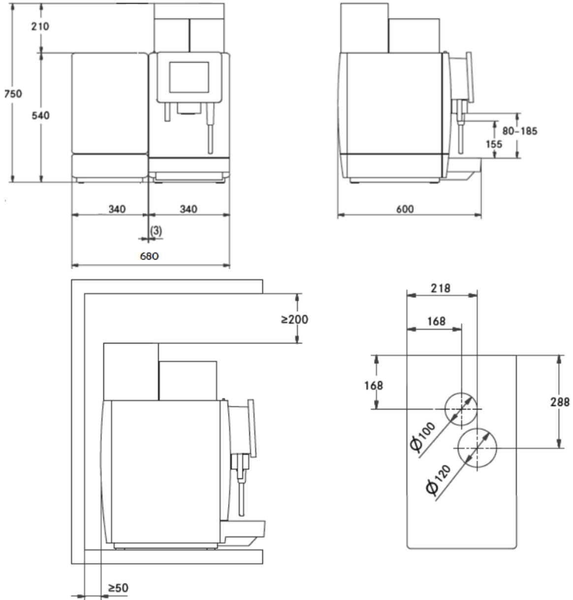
Dimensiones en el lugar de montaje/Paso de tubos flexibles por el mostrador
